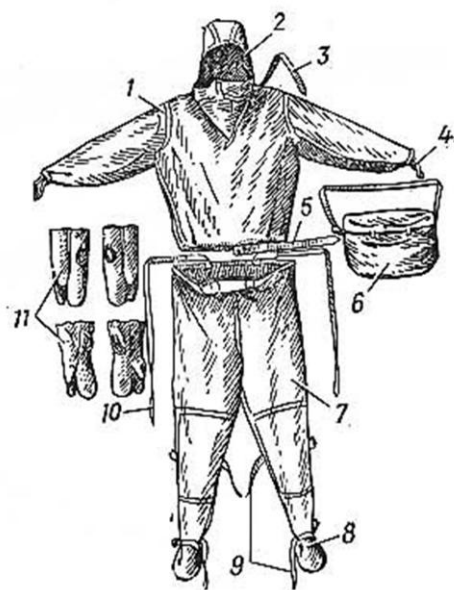
Рис. 6.11. Легкий защитный костюм: 1 — куртка; 2 — капюшон; 3 — головной хлястик; 4 — петли; 5 — промежуточный хлястик; 6 — сумка; 7 — брюки; 8 — боты; 9 — хлястики; 10 — бретели; 11 — носочки
